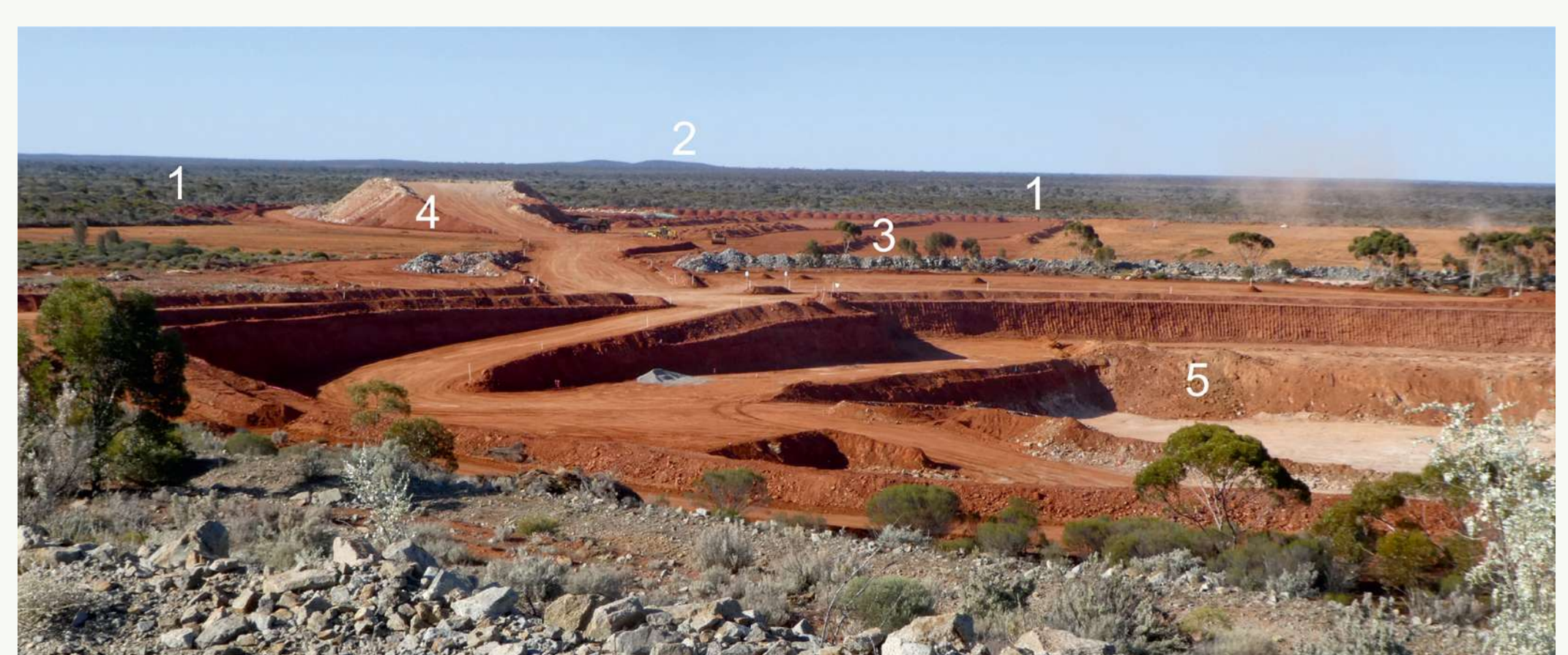
➤ Figura 1. Apertura de una explotación minera en Australia occidental. Al fondo puede intuirse el bosque original, sobre una gran llanura (1) salpicada por pequeños relieves residuales (2). En el centro (3) se observa la retirada del suelo; (4) muestra el inicio de construcción una escombrera exterior. A la derecha (5) pueden observarse las primeras fases de excavación de la corta o hueco minero (pit). Es en contextos como este donde la RG es necesaria, para integrar funcional y visualmente en su entorno todo el espacio transformado. Autor: J.F. Martín.
